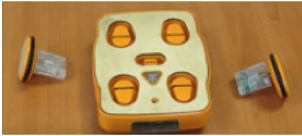
El robot KIBO con ruedas y motores
