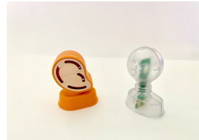
Módulos de entrada (input) y salida (output) (Sensor de sonido y lamparita)
